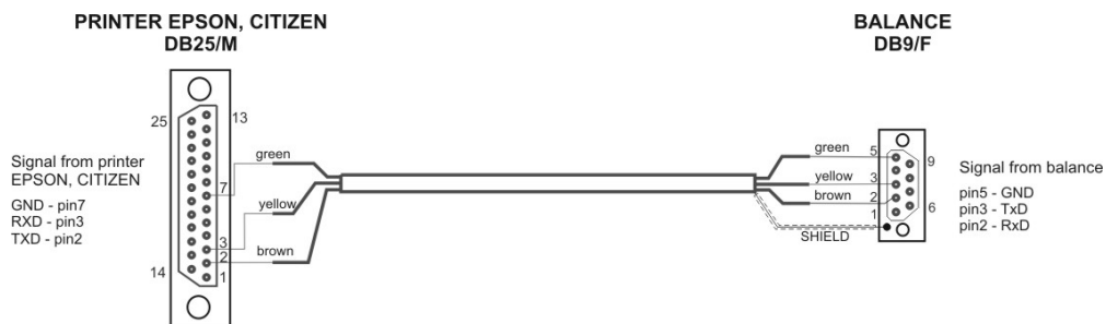
Esquema de cable, balanza - impresora (EPSON)
