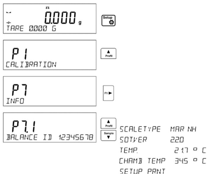
Después de seleccionar el parámetro <Impresión de los ajustes > se enviarán a la impresora los ajustes de la balanza (todos los parámetros) Los parámetros se enviarán a través del puerto seleccionado para <IMPRESORA>.
