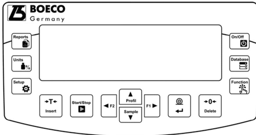
Durante los intervalos entre series de mediciones, no desconecte la balanza de la red. Se recomienda apagar la pantalla de la balanza presionando el botón **ON/OFF**. Después de presionar nuevamente el botón **ON / OFF**, la balanza está lista para el próximo pesaje.
