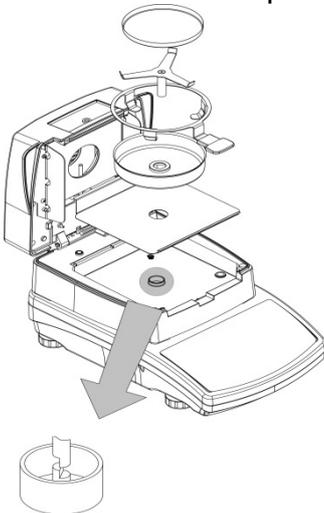
Al instalar el soporte en forma de cruz (soporte de la bandeja) preste especial atención al correcto posicionamiento de su mandril. El mandril presenta un corte que proporciona una posición única del soporte contra el mango de la bandeja, evitando así su contacto y fricción.
