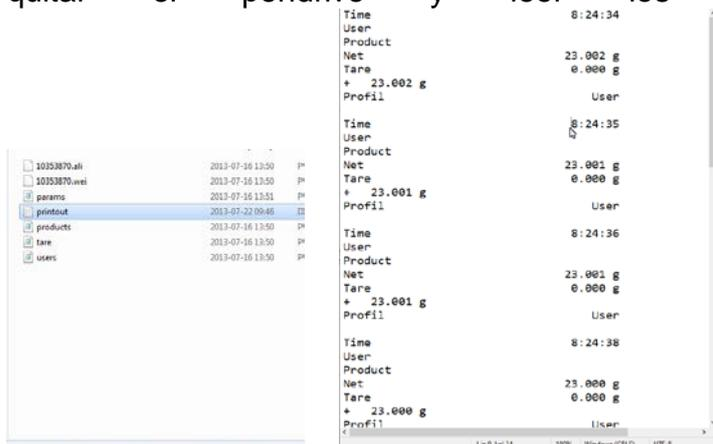
Después de volver a colocar el pendrive en USB, el programa de pesaje agregará datos al archivo ya creado en el pendrive, para que el usuario pueda continuar guardando las mediciones en el mismo archivo.
