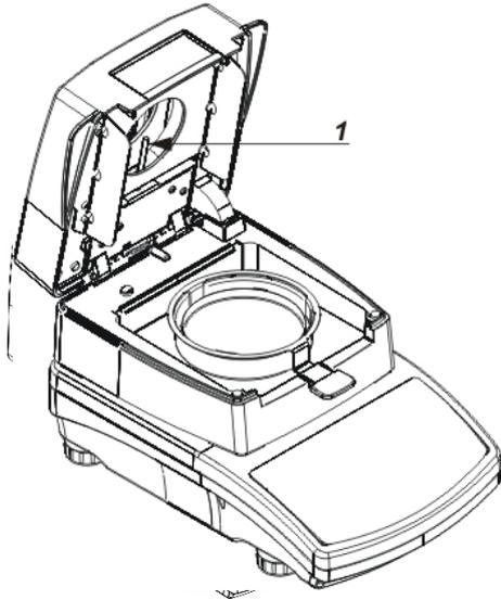
Abra la tapa del analizador de humedad y retire todos los componentes: platillo desechable, mango de la bandeja de secado, soporte en forma de cruz, protector de la bandeja de secado, inserto de la base de la cámara de secado. Para la limpieza, use un material delicado (tetra, gamuza, etc.) y agentes de limpieza suaves.
