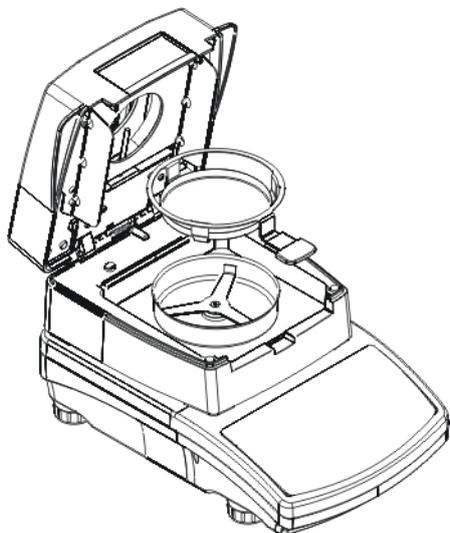
Coloque el platillo desechable en un asa de bandeja y dépositelo en un soporte. La pantalla muestra el peso del platillo desechable.
