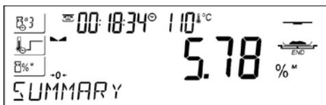
Al finalizar el proceso de secado, se muestra el resumen de la prueba, y el resultado final del contenido de humedad
