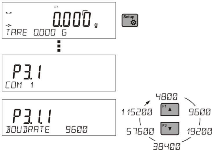
Para los ajustes de los puertos RS 232 el programa de balanza tiene los siguientes parámetros de transmisión:
